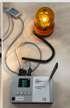
Leuchtfeuer, die anzeigt, dass die eingestellte Temperatur überschritten wurde
