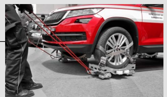
Verschiebung eines beschädigten Elektrofahrzeugs mit Transportwagen
