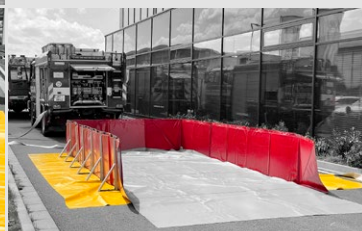
Platzierung eines beschädigten Elektroautos in den Quarantäne- Container
