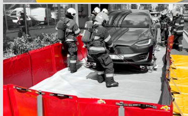
Platzierung eines beschädigten Elektroautos in den Quarantäne- Container
