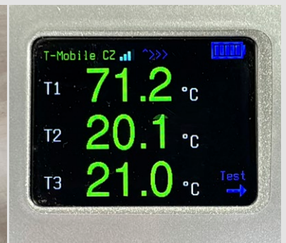
Temperaturgrenzwert-Alarm – das Gerät sendet eine Warn-SMS
