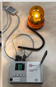
Maják ohlašující překročení stanovené teploty
