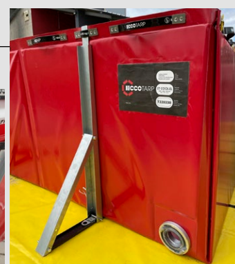
Skládací kontejner naplněný vodou. Objem 14 400 l.
